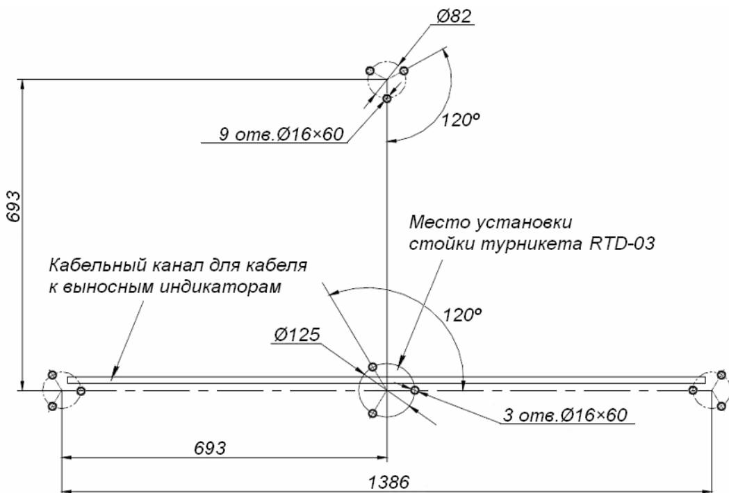
**Рисунок 3. Разметка для установки стоек формирователя прохода**
